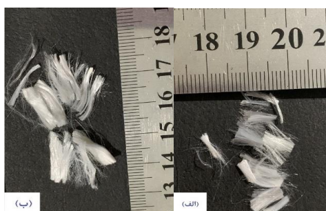
شکل ۱: الیاف پلی پروپیلن مصرفی با طولهای مختلف (الف) با طول ۶ میلی متر، (ب) با طول ۱۲ میلی متر
