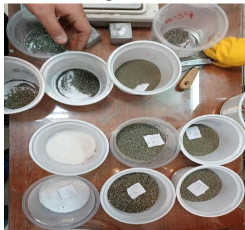
شکل ۱- مصالح مصرفی وزن شده بر اساس طرح اختلاط
