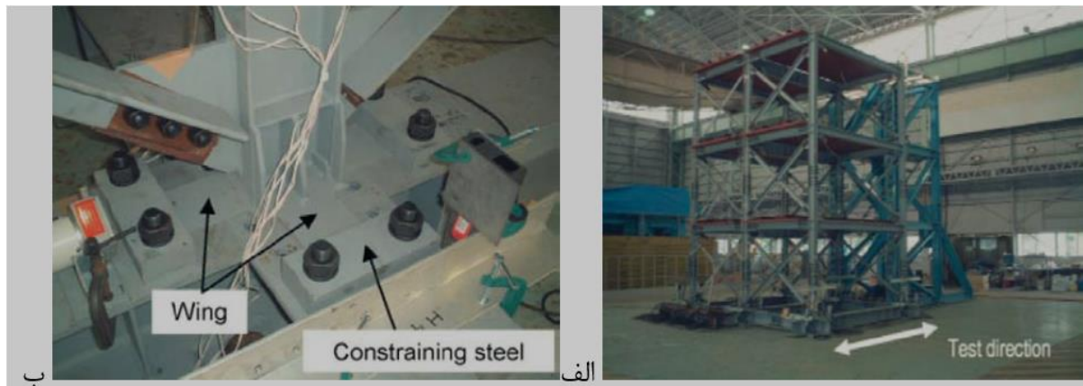
شکل ۴: آزمایش میز لرزان قاب فولادی دارای کف ستون های جاری شونده (الف) تصویر نمونه آزمایشگاهی (ب) نمای از نزدیک کف ستون جاری شونده (Iwishita, 2002)
