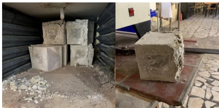
شکل ۴: تغییرات ظاهری نمونه‌های شاهد بدون الیاف بعد از حرارت دیدن
