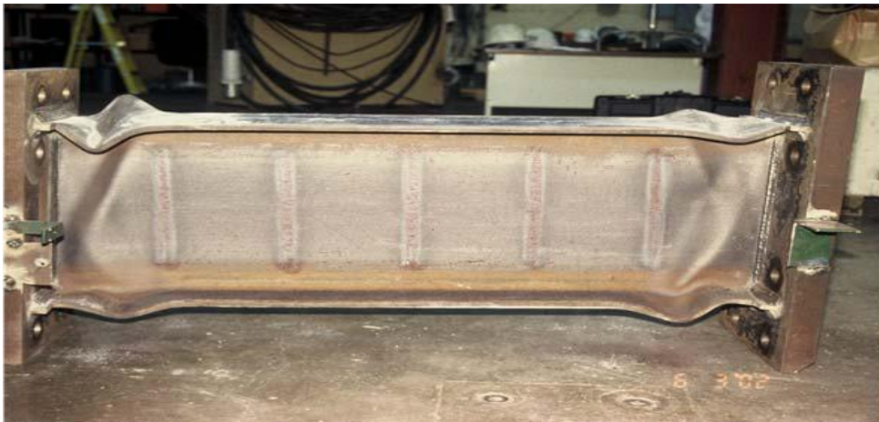
شکل ۴: کمانش تیر پیوند در مهاربند واگرا. (Micheal, 2007)
